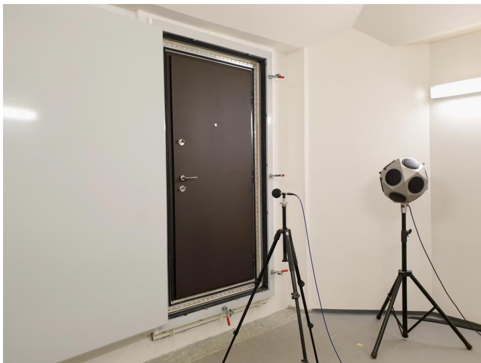
Celkový pohľad na dvere osadené v deliacej konštrukcii z prijímacej komory
